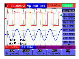
Figure 23: Edge Trigger
